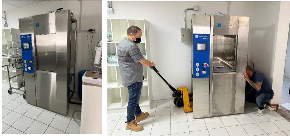
En la Central de esterilización se realizó un profundo cambio en su equipamiento pasando de una autoclave de sobremesa con capacidad de 27 litros a un moderno equipo autoclave de 200 litros lo que permite aumentar notoriamente la productividad y eficiencia de la unidad, logrando optimizar su funcionamiento en la entrega de material estéril a los ocho servicios que lo requieren diariamente.
